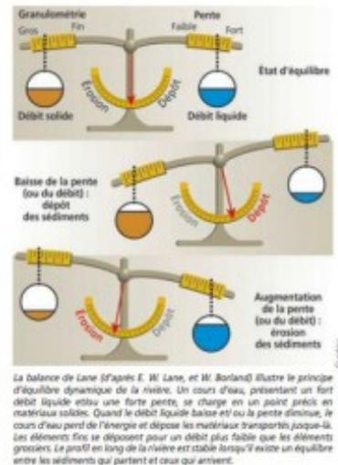
Figure 2 : Schéma de la balance de Lane (OFB, 2012)
