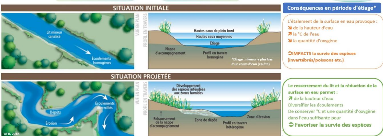
Figure 5 : Schéma explicatif d'un cours d'eau recalibré et d'un cours d'eau naturel
